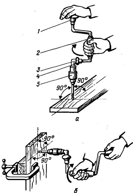
**Рис. 14:** Приёмы сверления древесины коловоротом: а — при горизонтальном положении детали; б — при вертикальном положении детали, зажатой струбциной (1 — нажимная головка; 2 — ручка; 3 — кольцо переключения; 4 — храповой механизм; 5 — зажимной патрон)
