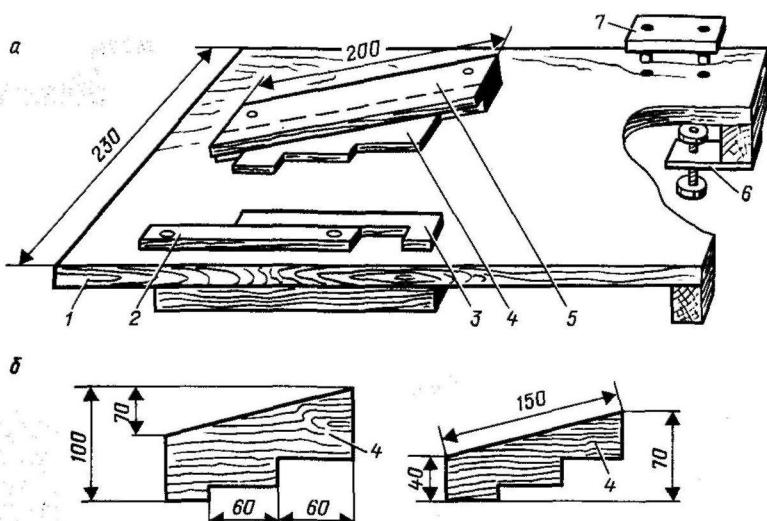
**Рис. 5:** Настольная столярная доска: 1 — основание доски; 2 — упор; 3 — вырез в упоре; 4 — металлические штыри; 5 — прорезь; 6 — гнёзда под клин.
