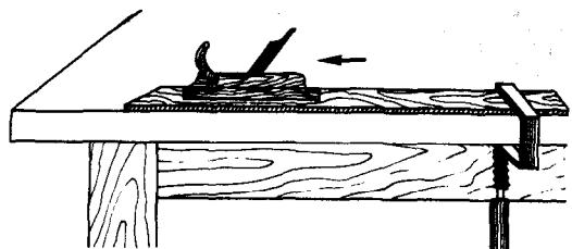
**Рис. 32:** Зачистка пластинки пиленного шпона рубанком
