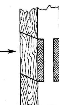
(сильный износ, повреждение гвоздями и шурупами, трещинами по периметру) этот участок заменяют. На рис. 27 показана замена повреждённого участка древесины на царге стула.
