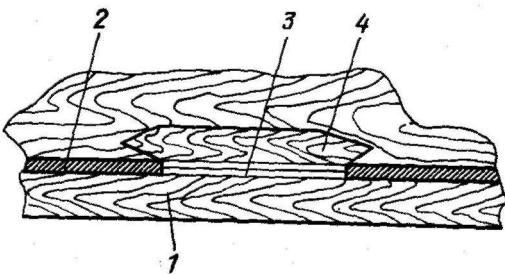
**Рис. 1.** Восстановление облицовочного слоя: 1 — основа; 2 — пиленый шпон; 3 — черновая рубашка (вспомогательный слой); 4 — строганый шпон (вставка)
