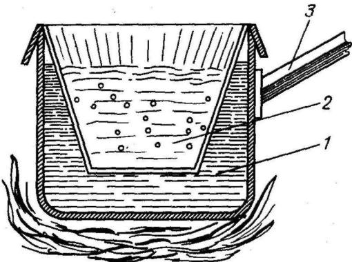
**Рис. 3:** Разогрев клея:
