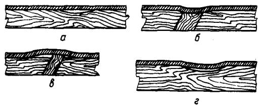
**Рис. 31:** Дефекты в облицовке: а — воздушный пузырь — «чиж»; б — проседание облицовки над сучком; в — выпячивание сучка; г — вмятина на поверхности предмета под облицовкой
