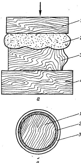
**Рис. 30:** Оклейивание криволинейных поверхностей: а — с помощью сыпучих цулаг (1 — верхнее основание зажимного приспособления; 2 — сыпучие цулаги, то есть мешки с песком; 3 — деталь с криволинейной поверхностью; 4 — нижнее основание); б — с помощью резиновой обвязки (1 — фасонная поверхность детали; 2 — облицовочный слой; 3 — резиновый жгут)
