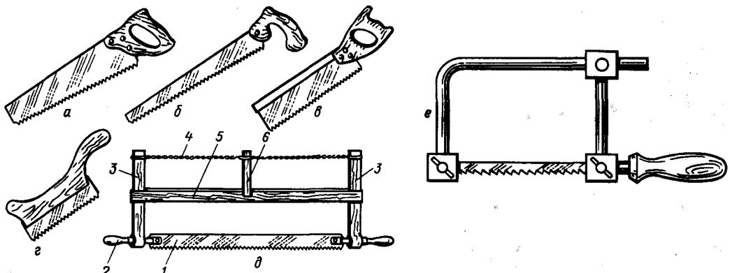
**Рис. 7:** Инструмент для пиления: а — поперечная ножовка (широкая); б — узкая ножовка; в — ножовка с обушком; г — ножовка-наградка; д — лучковая пила (1 — полотно; 2 — ручка; 3 — стойки; 4 — тетива; 5 — средник; 6 — закрутка); е — лобзик
