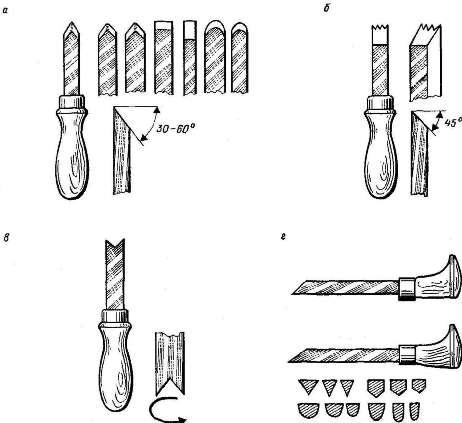
**Рис. 19:** Инструмент для гравирования:
