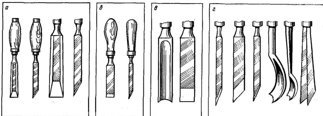
**Рис. 9:** Долбёжный инструмент: а — долота столярные; б — стамески плоские столярные; в — стамески полукруглые столярные; г — резчицкие стамески.
