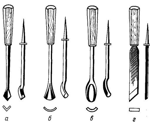
**Рис. 18:** Инструмент (основной) для резьбы по дереву: а — стамески-уголки; б — стамески-ключарзы; в — стамески-церазики; г — ножкосяк
