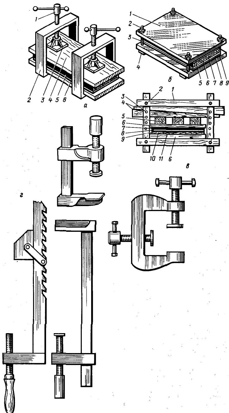
**Рис. 20:** Приспособления и инструменты для склеивания (прессы и струбцины):
