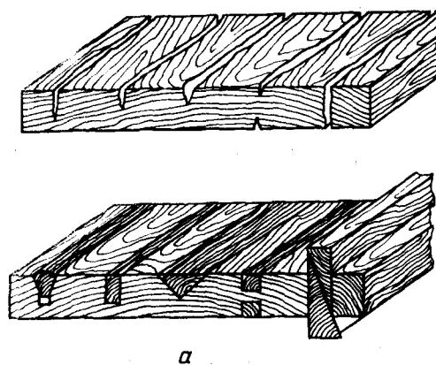
**Рис. 25:** Заделка трещин: а — в щитовом элементе; б — в филёнке из массива древесины
