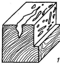
**Рис. 27:** Замена испорченной древесины: 1 — испорченный участок; 2 — удаление непригодной древесины; 3 — наращивание необходимой утраты
