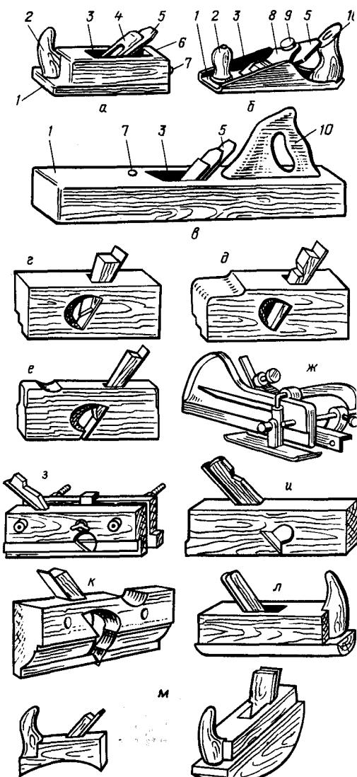
**Рис. 11:** Строгальный инструмент: а — деревянный рубанок; б — металлический рубанок; в — фуганок (1 — корпус; 2 — державка; 3 — леток 4 — клин; 5 — нож; 6 — упор; 7 — пробка 8 — прижим; 9 — винт; 10 — ручка); г — отборник; д — фальцгебель; е — зензубель; ж — шпунтубель; з — грунтобель; и — штап; к — калевка; л — галтель; м — горбачи (с вогнутым к выпуклым дном).
