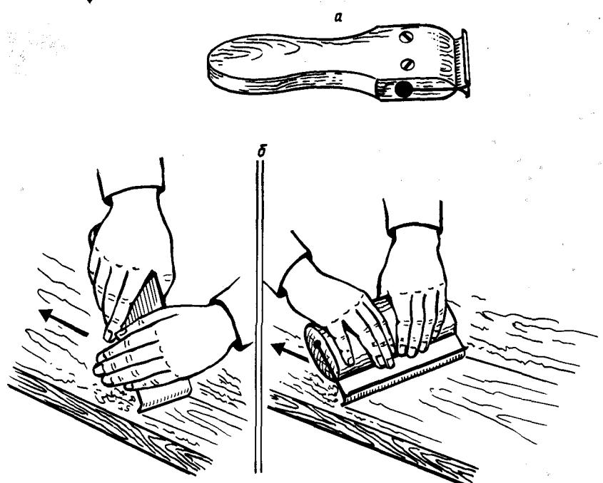
**Рис. 15:** Циклевание поверхности: а — цикля серийного производства; б — самодельная цикля (узкая и широкая) и положение рук при циклевании
