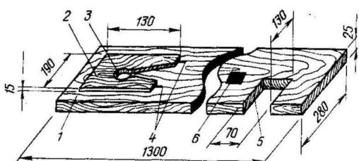
**Рис. 4:** Съёмная крышка столярного верстака: а — конструкция крышки (1 — основание; 2 — боковая рейка; 3 — вкладыш; 4 — упор для строгания; 5 — направляющая; 6 — струбцина для крепления верстака к крышке стола; 7 — упор для пилинья); б — сменные упоры для строгания.
