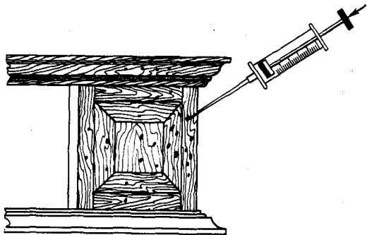
**Рис. 21:** Дезинфицирование мебели при помощи шприца
